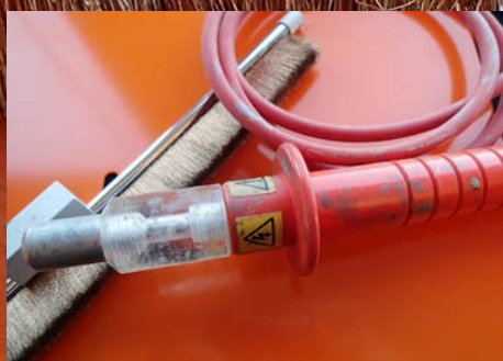
Испытание на пористость может использоваться для проверки наличия микроотверстий или минимальной толщины покрытия с целью предотвращения преждевременного повреждения системы покрытия.
