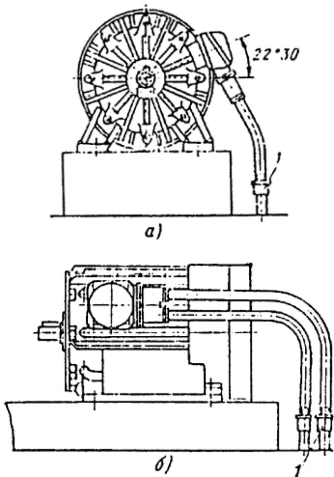
Рис. 75. Подвод труб к электродвигателям серии ВАО 315 — 450-го габаритов.
