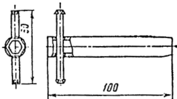
Рис. 89. Ключ для стяжных болтов и светильников ВЗГ-100 и В4А-60
