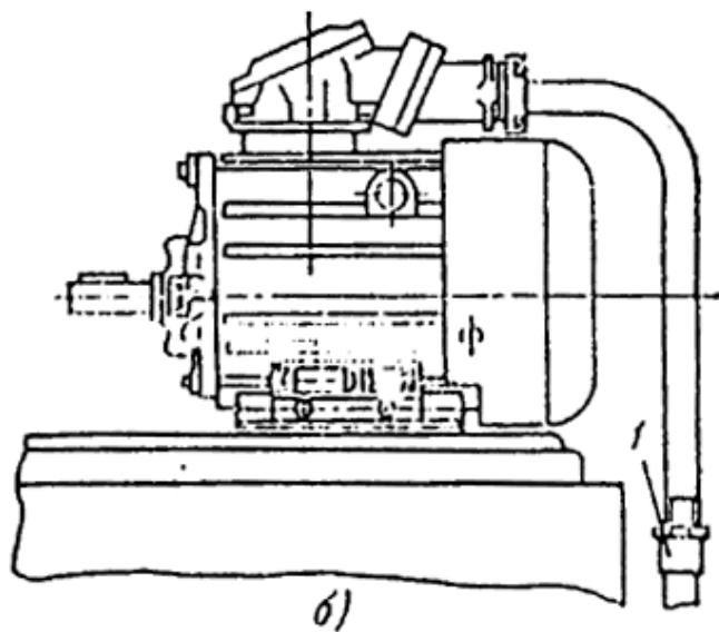
Рис. 74. Подвод трубы к электродвигателям 4 — 8-го габаритов.
