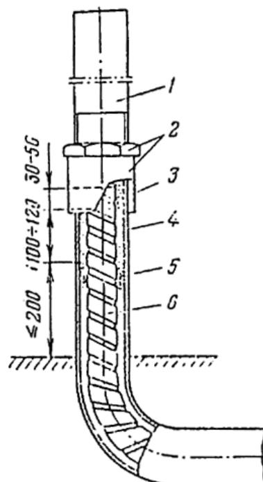
Рис. 29. Разделительное уплотнение кабеля в трубе с условным проходом более 50 мм.
