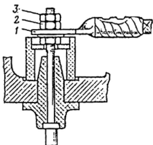
Рис. 2. Присоединение алюминиевых жил сечением более  $16 \text{ mm}^2$  с применением медно-алюминиевых наконечников.
