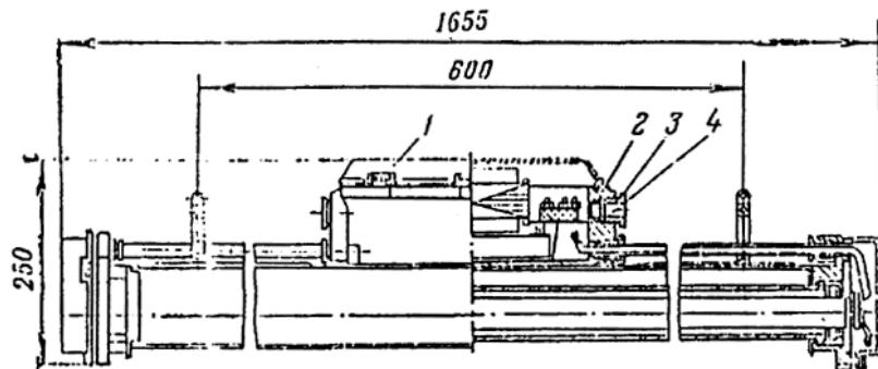
Рис. 92. Светильник повышенной надежности против взрыва НОГЛ-80.
