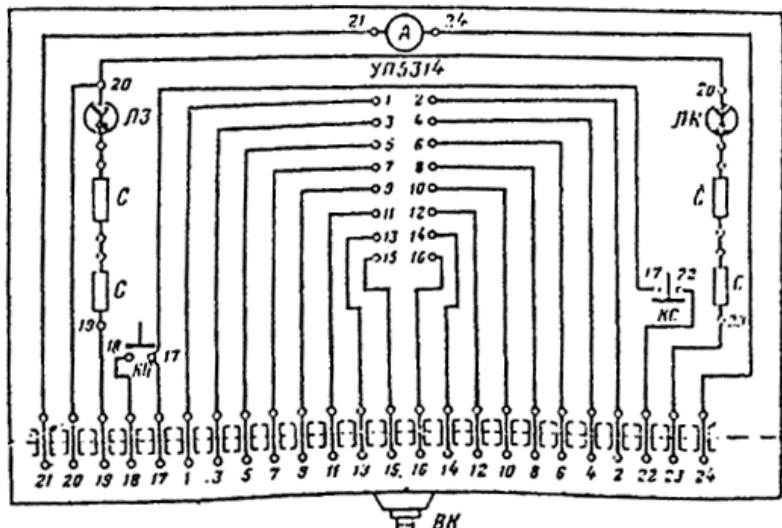
Рис П9-б. Электрическая схема колонки управления К-3Г.
