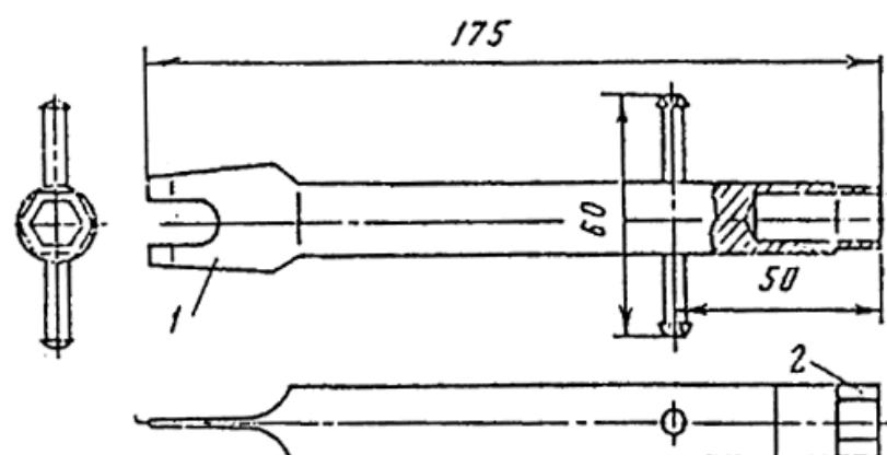
Рис. 97. Ключ для светильника Н4Б-300.
