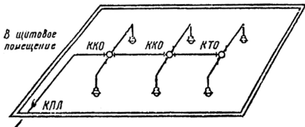
Рис. 28. Вариант выполнения разводки трубопроводов осветительной сети в помещениях классов В-Іа и В-ІІ.
