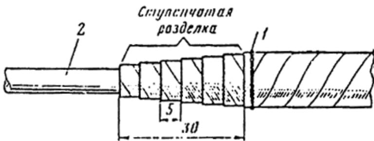
Рис. 54. Снятие изоляции с конца однопроволочной жилы.
