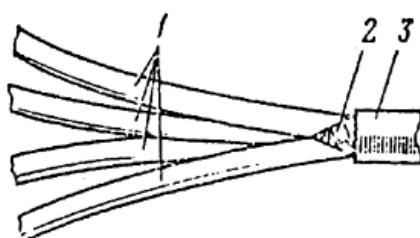
Рис. 48. Трубы ХВТ, надетые на жилы кабеля.
