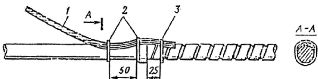
Рис. 42. Закрепление заземляющего проводника на кабеле.
