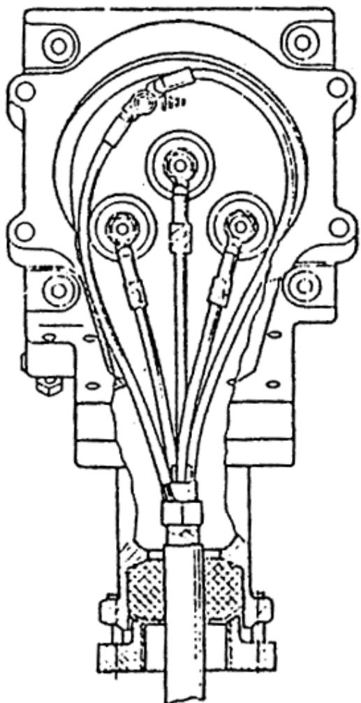
Рис. 71. Ввод и присоединение кабеля марки ВБВ (АВБВ) во вводном устройстве
