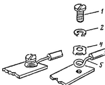
Рис. 1. Присоединение однопроволочных алюминиевых жил сечением до  $16 \text{ mm}^2$
