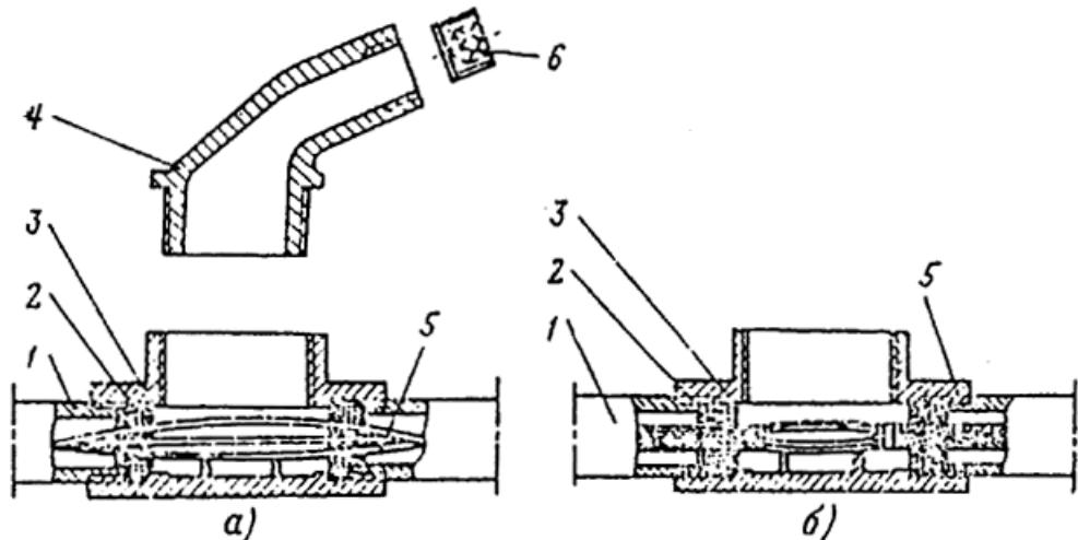
Рис. 37. Подготовка коробки КПР для выполнения разделительного уплотнения.
