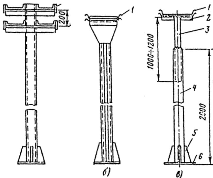
Рис. 5. Примеры стоек для установки лотков.
