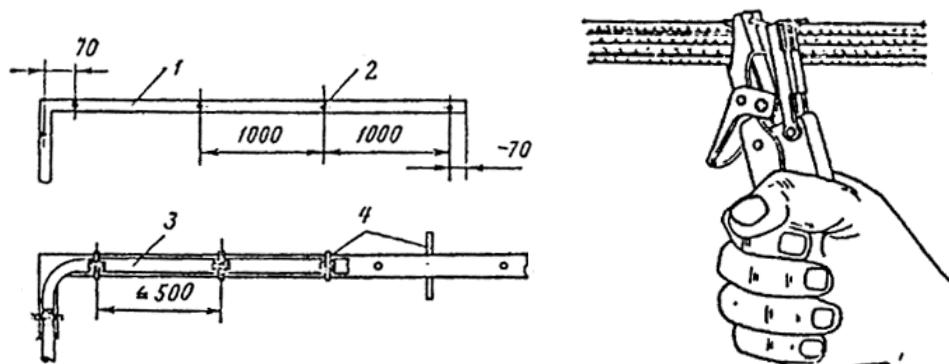
Рис. 18. Крепление кабелей на металлических полосах и лентах.
