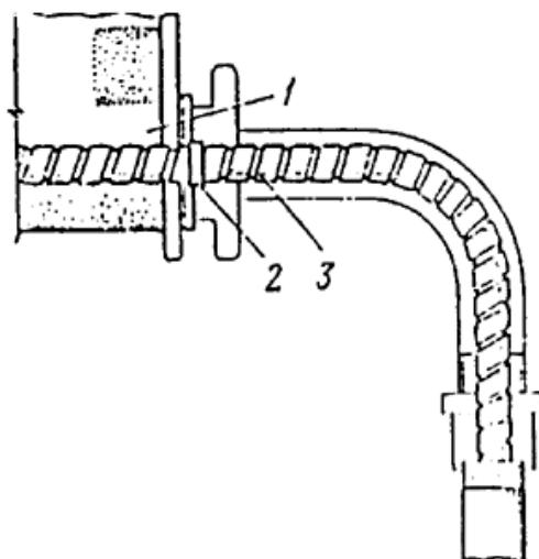
Рис. 41. Примерка кабеля и наложение бандажа.
