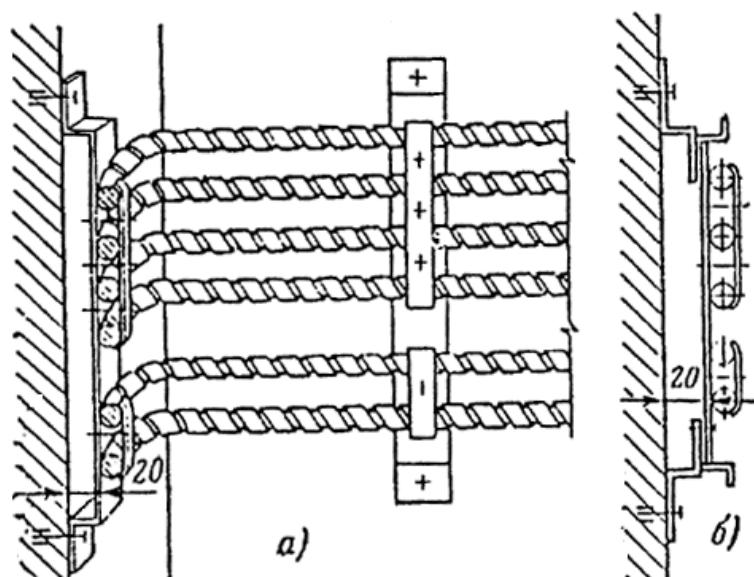
Рис. 10. Прокладка кабелей во взрывоопасных зонах классов В-II и В-IIa.
