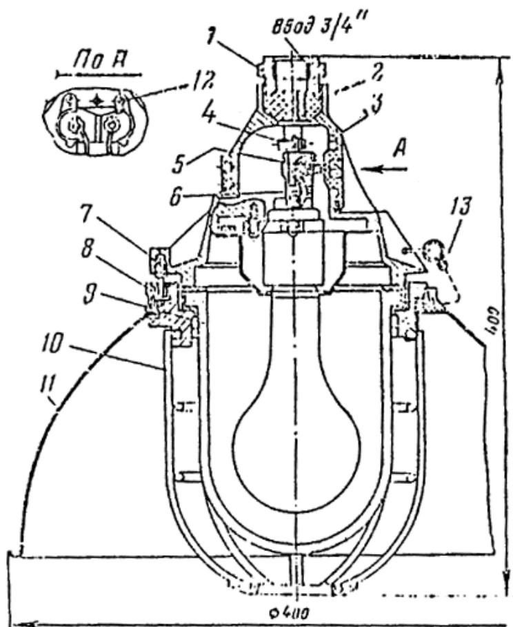
Рис. 84. Светильник Н4БН-150 с вертикальным вводом кабеля.
