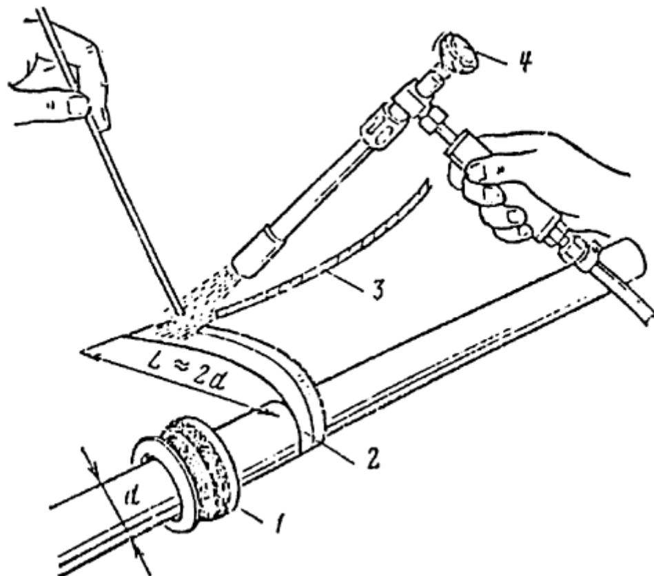
Рис. 39. Припайка заземляющего проводника к броне кабеля марки ВБВ и АВБВ при вводе кабеля в вводные устройства.
