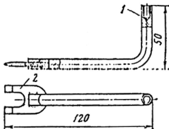
Рис. 96. Ключ для монтажа светильников В3Г-200А и В3Г/В4А-200.
