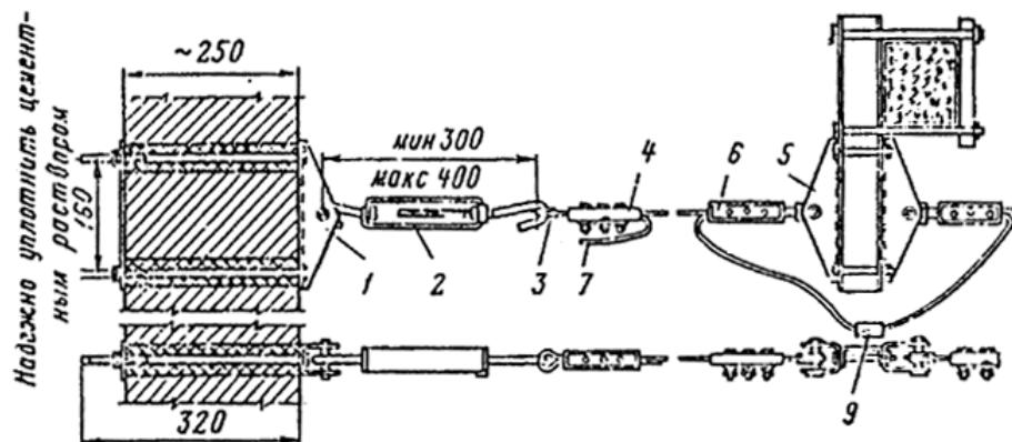
Рис. 21. Пример анкерного крепления троса (проводки) и соединение его на промежуточной опоре.
