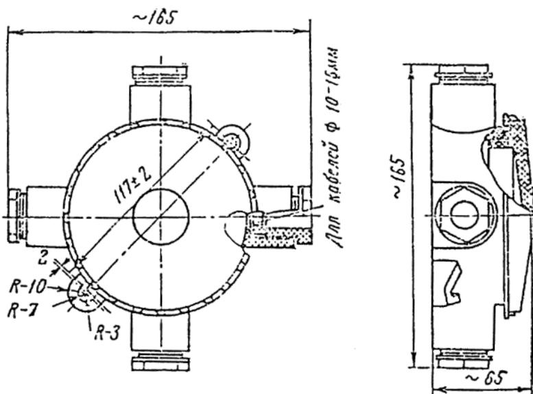
Рис. П4-1. Габаритные и установочные размеры коробки У409 по ТУ 36.1859-75.
