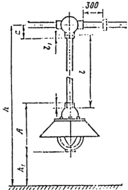
Рис. 103. Прямой спуск к светильнику.
