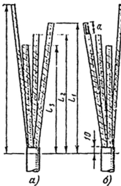
Рис. 72. Длина жил при подготовке кабелей к заделке для электродвигателей серии ВАО 316 — 460-го габаритов и серии МАЗ6 6 — 7-го габаритов.
