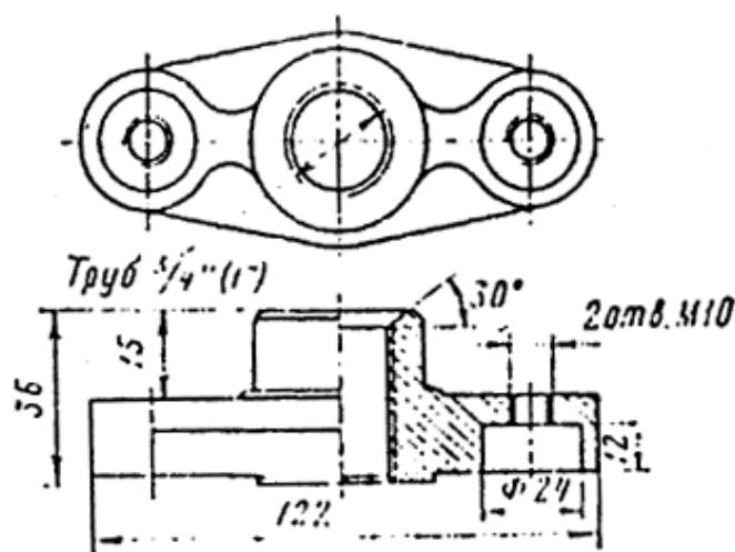
Рис. 59. Нажимная муфта вводного устройства K-1.
