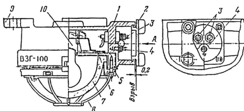
Рис. 88. Взрывозащищенный светильник В3Г-100.
