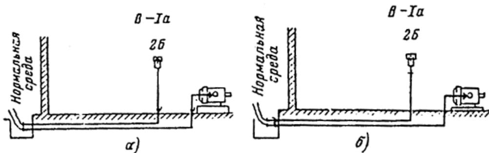
Рис. 33. Пример установки разделительных уплотнений при проходе труб из взрывоопасного помещения в нормальное.
