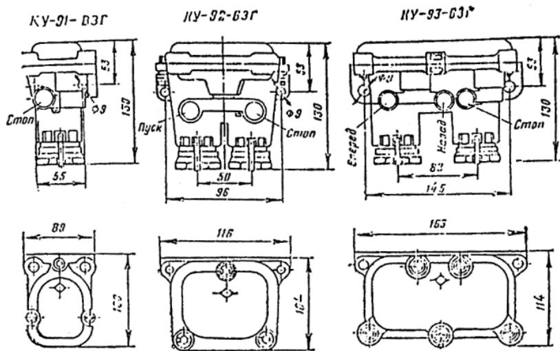
Рис. П9-3. Посты управления взрывонепроницаемые КУ-90-В3Г.
