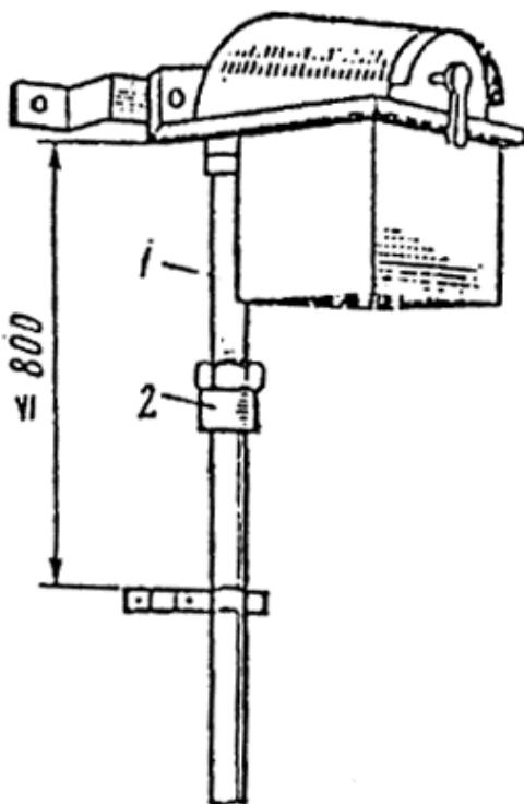
Рис. 82. Ввод трубопровода в пост управления КУ-700.
