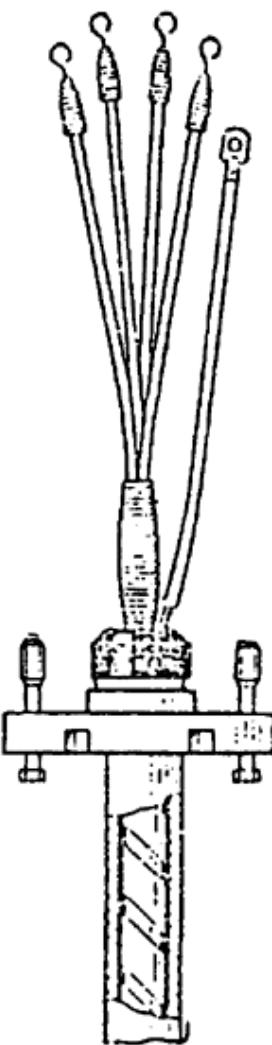
Рис. 52. Общий вид сухой заделки кабеля перед вводом в вводное устройство электродвигателя до третьего габарита.
