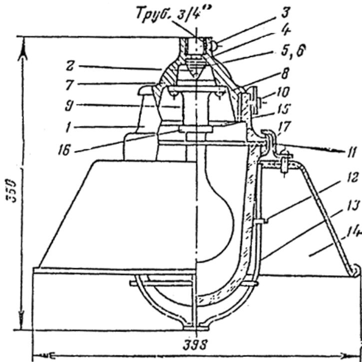
Рис. 93. Светильник взрывонепроницаемого исполнения В3Г-200А.
