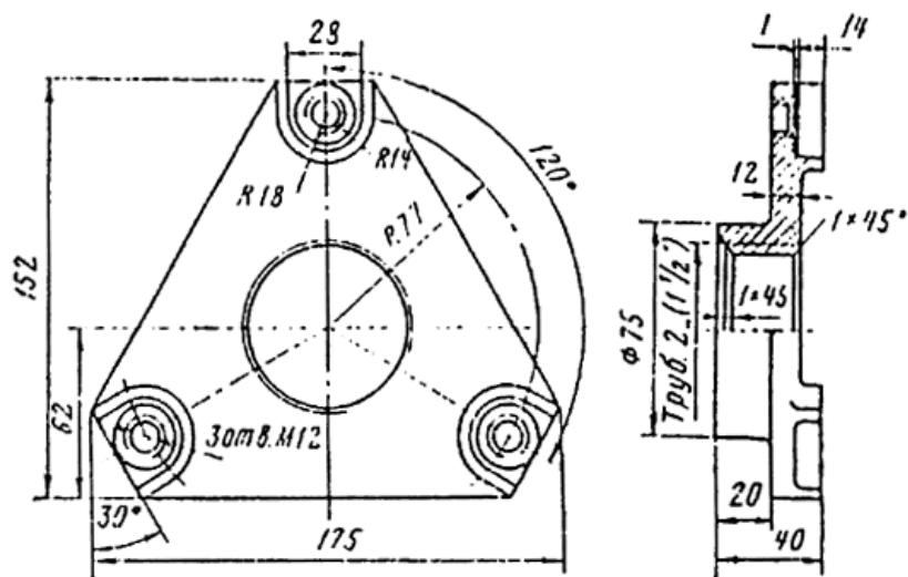
Рис. 60. Нажимная муфта вводных устройств K-2, K-3, K-5.
