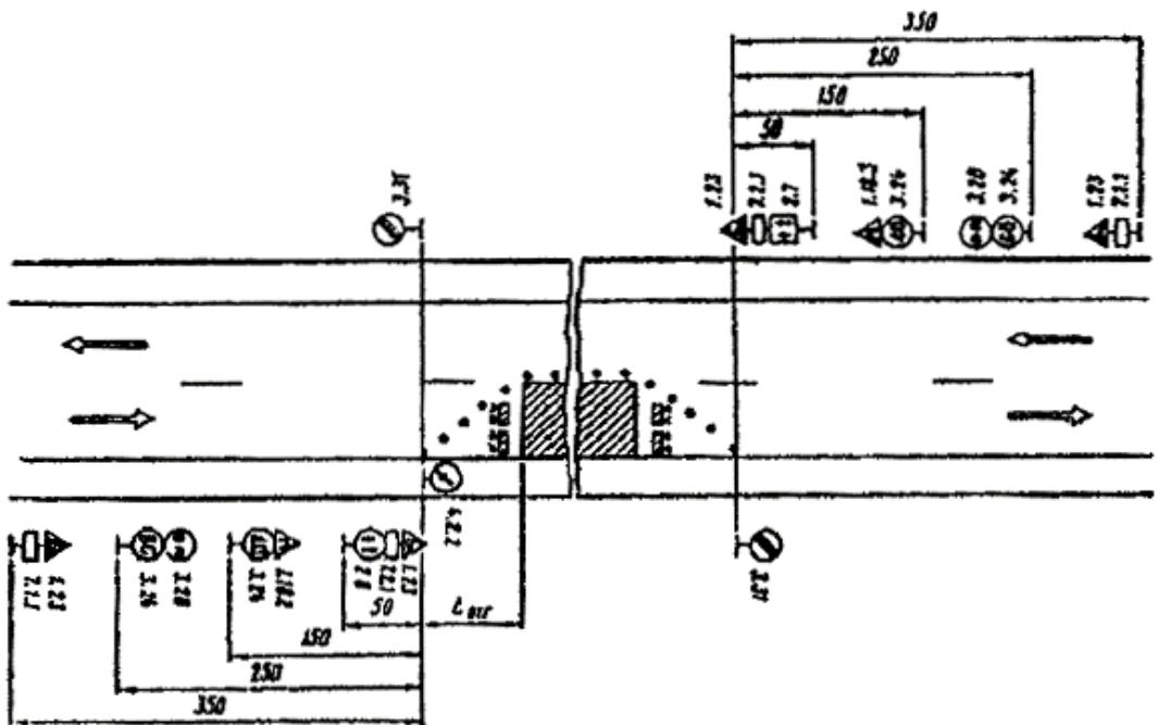
Рис. 3.2. Организация движения и ограждение места дорожных работ, выполненных на половине ширины проезжей части двухполосных дорог
