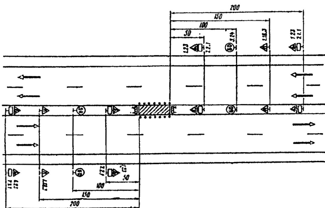
Рис. 3.7. Организация движения и ограждение места дорожных работ, выполняемых на разделительной полосе многополосных дорог
