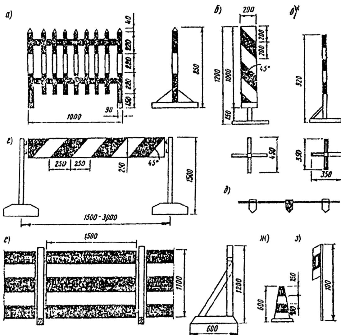
Рис. 4.2. Ограждения и направляющие устройства:
