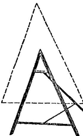
Рис. 4.1. Переносная опора для временного дорожного знака
