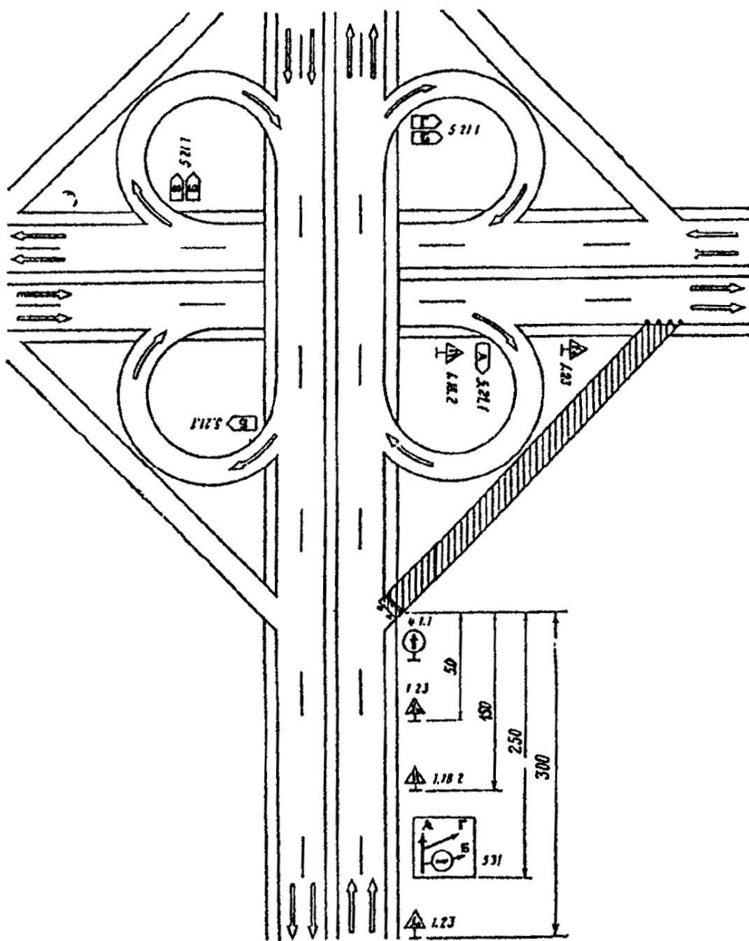
Рис. 3.24. Организация движения и ограждение места дорожных работ при закрытии правоповоротного съезда пересечения в разных уровнях с последовательным проездом трех левоповоротных съездов
