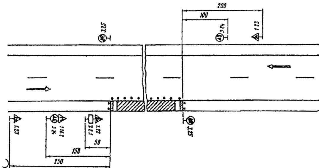
Рис. 3.1. Организация движения и ограждение места дорожных работ, выполняемых на обочине двухполосных дорог
