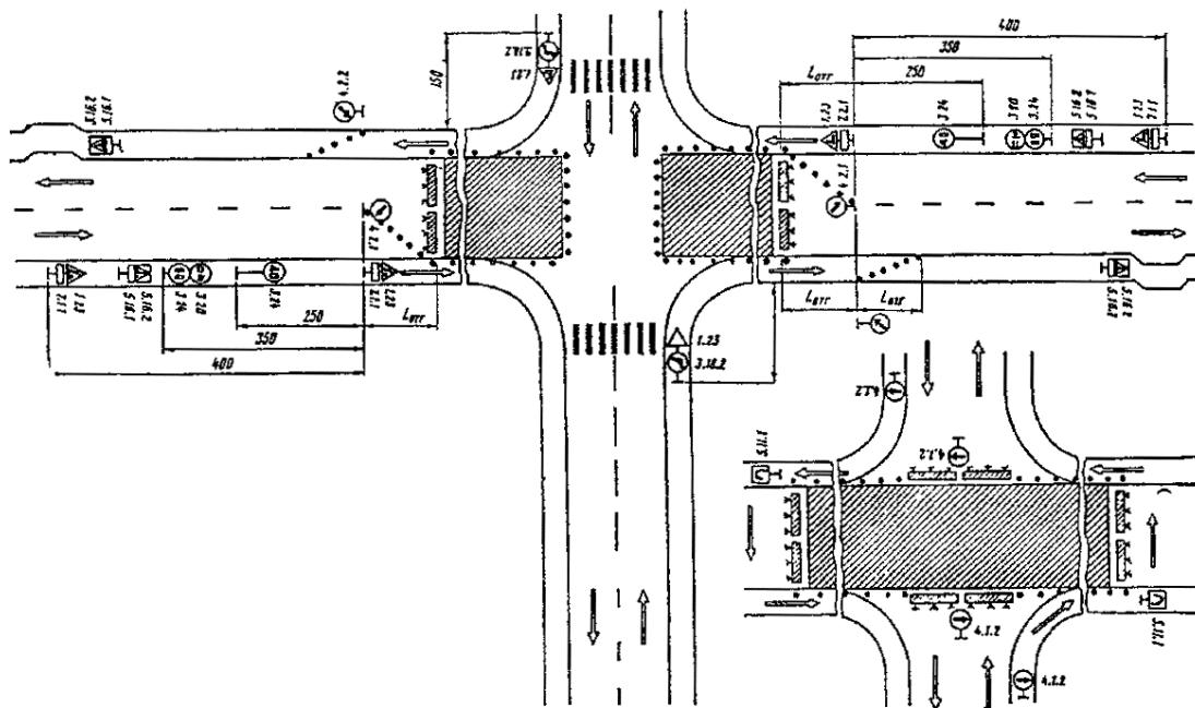
Рис. 3.16. Организация движения и ограждение мест дорожных работ, выполняемых на проезжей части главной дороги:
