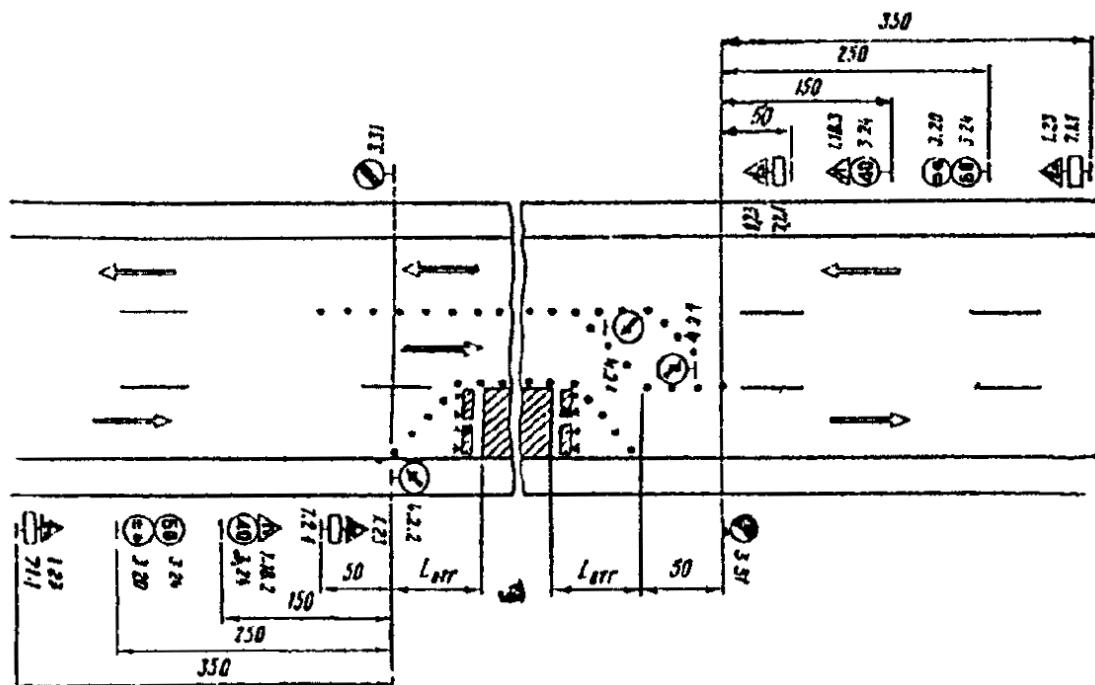
Рис. 3.4. Организация движения и ограждение места дорожных работ, выполняемых на крайней полосе движения трехполосных дорог
