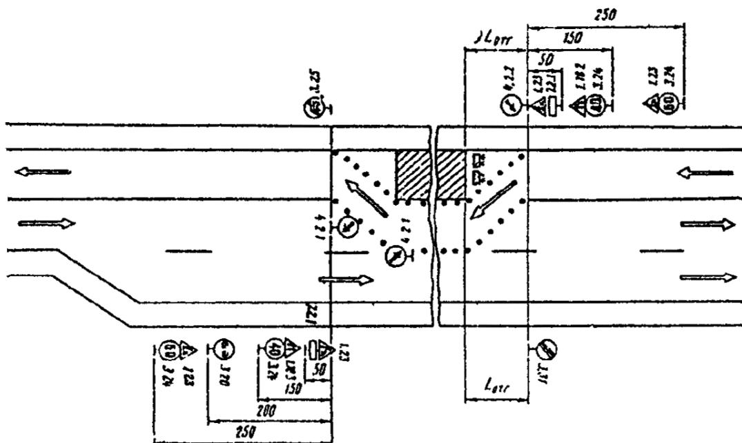
Рис. 3.12. Организация движения и ограждение места дорожных работ на участке затяжного подъема при их выполнении на полосе спуска
