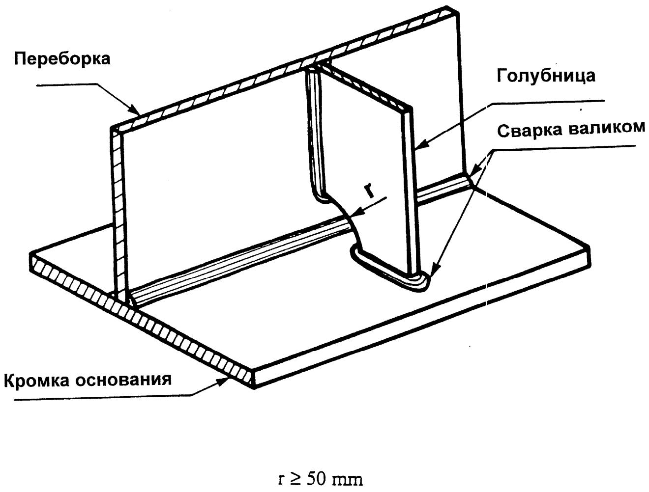
Рис.6 Применение упрочняющих элементов
