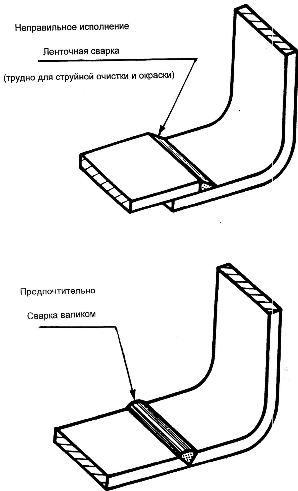
Рисунок 1 - Сварная конструкция
