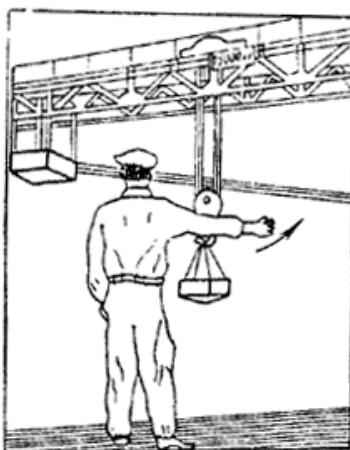
Рис. 7. Передвинуть кран (мост) назад: движение вытянутой рукой ладонью по направлению требуемого движения крана (моста)
