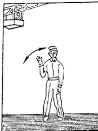
Рис. 11. Отключить магнит: одна рука опущена вниз, другая согнута в локте и ею в вертикальной плоскости на уровне головы делают частые движения
