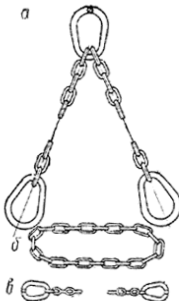
Рис. 23. Строповочные цепи: а — открытая с двумя ветвями; б — замкнутая; в — открытая с одной ветвью
