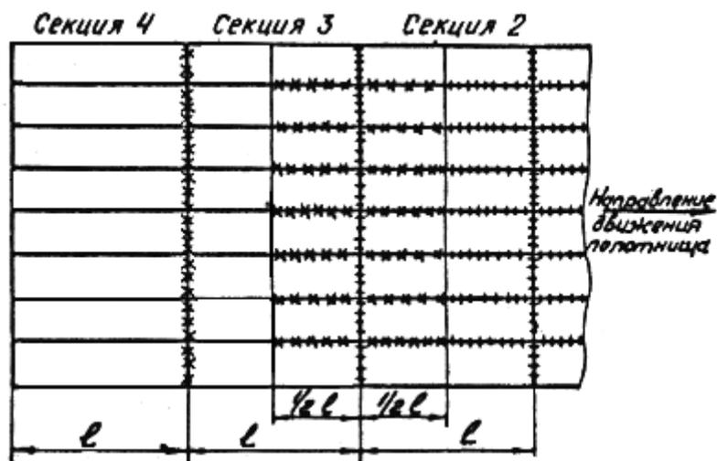
Рис. 3. Последовательность сварки полотнищ с совмещенными поперечными стыками:
